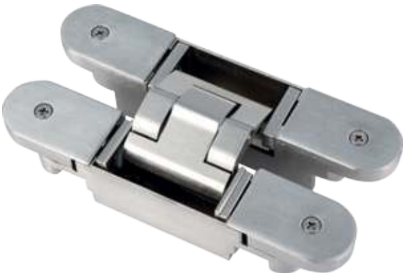
Bisagras ocultas de 3 regulaciones Incluye tornillos inox. para el montaje. La bisagra no tiene mano, independientemente para izquierda y derecha Invisible hinge with 3 regulations Including stainless steel screws for mounting. Regardless of left and right hinge
